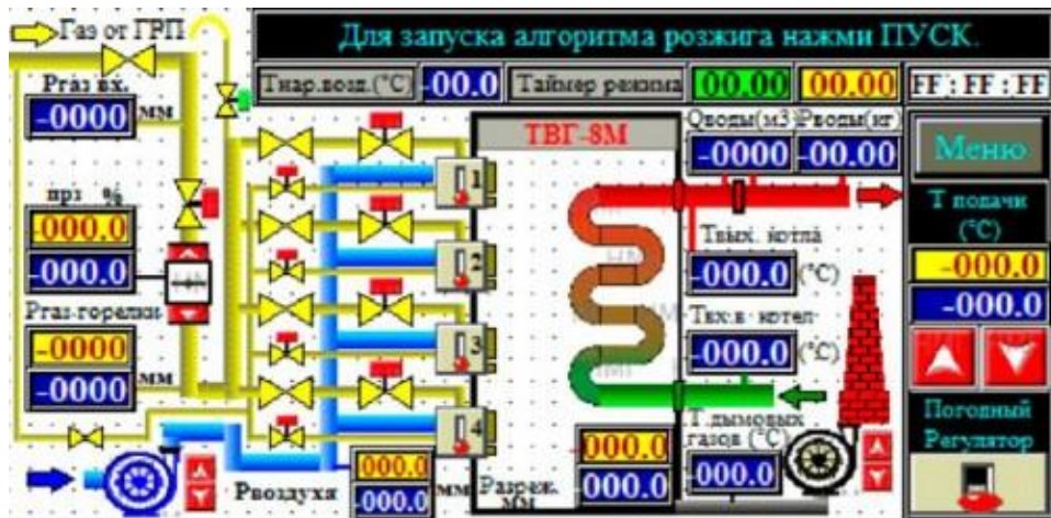
Малюнок 2.4. Головний екран. Мнемосхема котла ТВГ-8М
